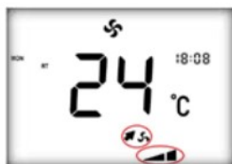
Ustawienie prędkości wentylatora nawiewnego
