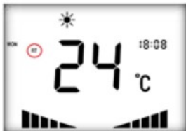
Temperatura powietrza powrotnego lub temperatura w pomieszczeniu
