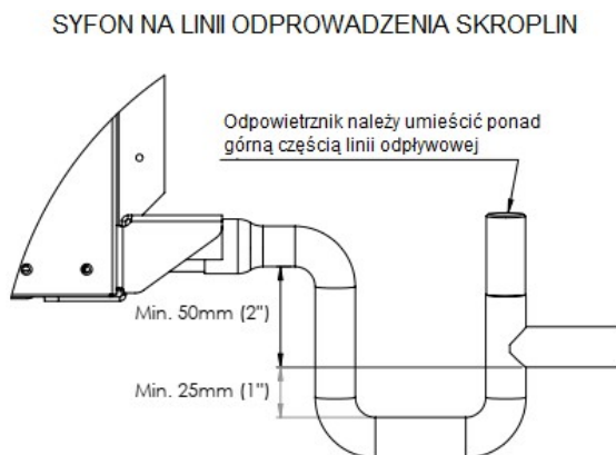
Rys. 8. Podłączenie odprowadzenia skroplin z jednostki poziomej
