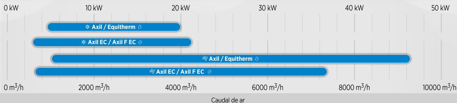
Capacidade de arrefecimento
