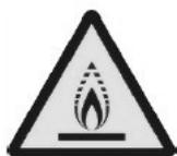
Das A2L-Logo auf dem Typenschild weist darauf hin, dass das Produkt ein Kältemittel der schwer entflammaren Kategorie enthält. Er wird auch auf den Schrader-Ventilen angebracht, an denen Kühlkomponenten zu Wartungszwecken angeschlossen werden können. Dieses Etikett weist Sie darauf hin, dass ein potenzielles Risiko besteht, dass entflammbares Gas austritt, und dass dies bei der betrieblichen Risikoanalyse berücksichtigt werden muss.
