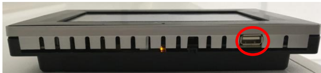
Image7: Port USB pour le chargement du programme
