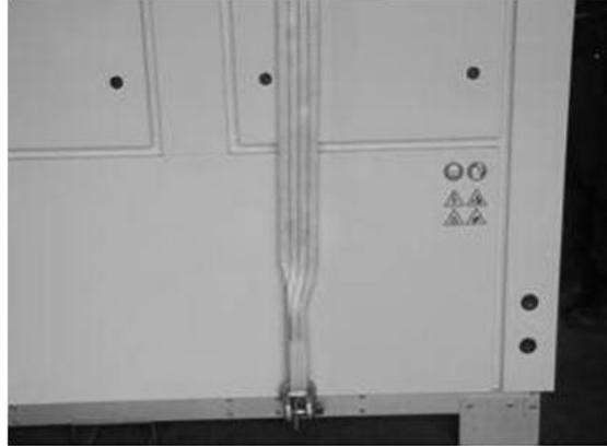
Nach dem Anheben die WinkelfüÙe und Hebeösen entfernen.
