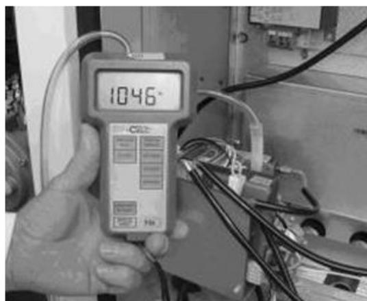
Der Auslassdruck muss an dem Druckanschluss gemessen werden, der sich auf der Gasinjektor-Tragleiste befindet, um einen Druckabfall aufgrund des Knies nach dem Ventil zu verhindern.
